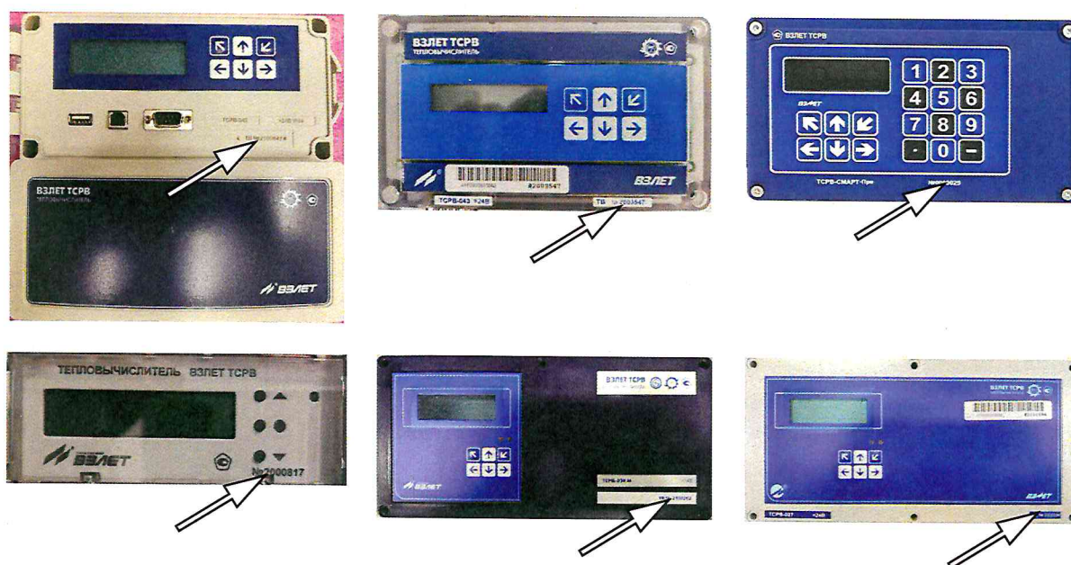
Рисунок 4 – Обозначение места нанесения заводского номера
