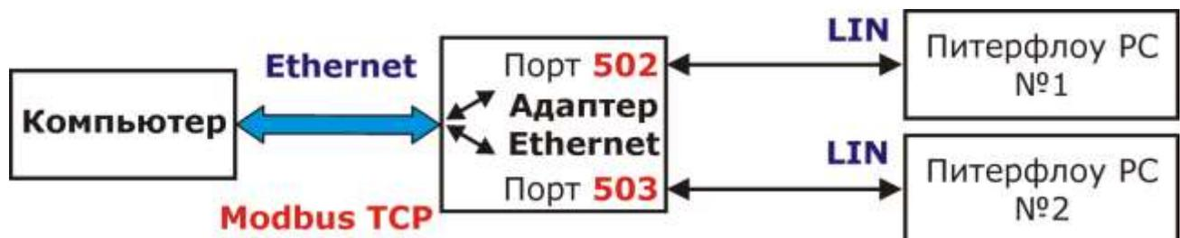
Рисунок 1: Адаптер Ethernet↔Прибор
