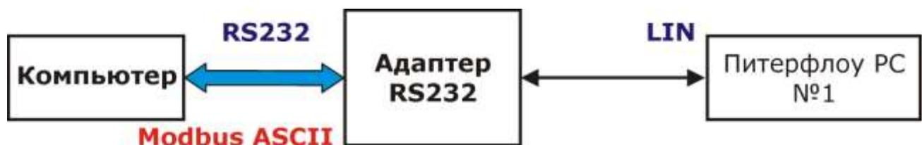
Рисунок 2: Адаптер RS-232↔Прибор
